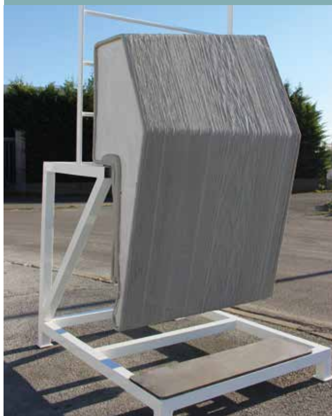
Prototype d'un garde-corps béton imprimé en 3D pour Rabot Dutilleul Construction en 2016.
